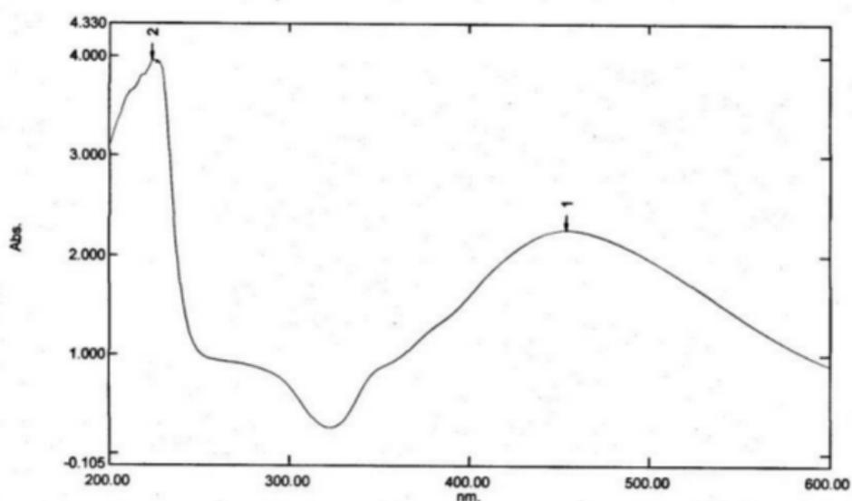
**Gambar 5. Hasil Spektrofotometer UV-Vis Larutan Nanopartikel Perak dengan Konsentrasi 5 mM**
