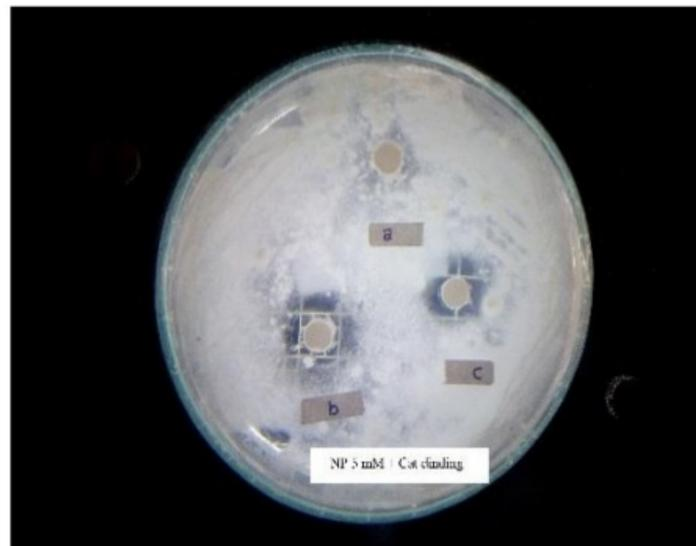
**Gambar 6. Contoh Diameter Anti-Jamur Cat Dinding yang Telah Diberi Larutan Nanopartikel Perak dengan Konsentrasi 5 mM**
